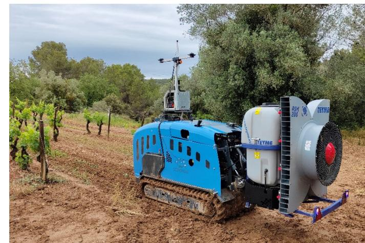
Robot a guida autonoma per il trattamento di filari di vite (posizionati anche in luoghi ad alta pendenza).
