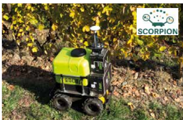
SCORPION: robot di precision spraying sicuro e autonomo, integrato in una piattaforma robotica e indirizzato all'utilizzo in vigneti a forte pendenza per l'agricoltura di precisione.
